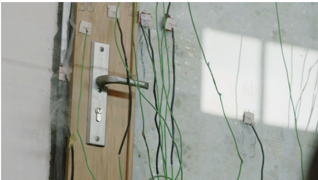
Dveře během požárních zkoušek.
