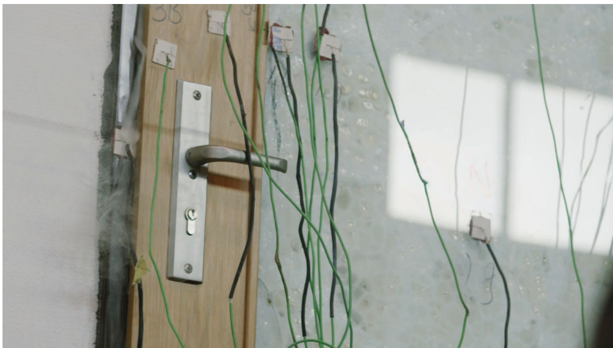
Dveře během požárních zkoušek.
