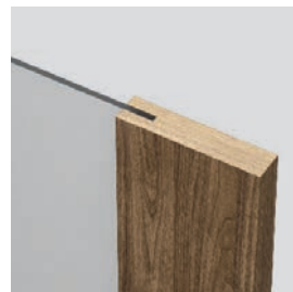
spojení se sklem „na hranu“ křídlo bezpolodrážkové
